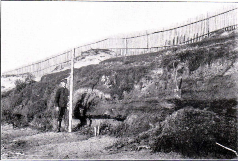
Abb. 8. Torfschicht im Uferabhang des Wolchow (an der Stelle des wa- gerechten Schattens; der daraus hervorragende Schwemmtou erstreckt sich bis zum unteren Ende des Spatens; S. 25).
