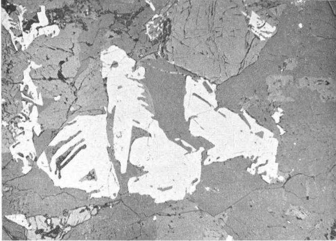
Abb. 5. Magnetit in »Olivindiabas«, Äsen, Elfdalen, Schweden. Magnetit, grob skelettförmig (lichtgrau), drei bis vier Silikate am Reflexionsvermögen erkennbar; das am hellsten reflektierende ist Olivin. Im Magnetit winzige Sulfidkörnchen. Übersichtsaufnahme, 5:1.
