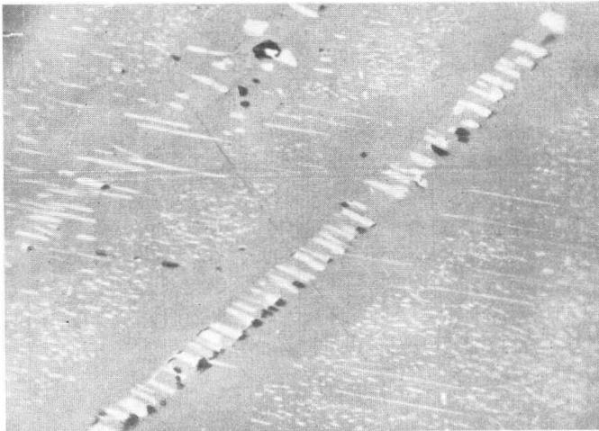
Abb. 42. »Magnetischer Ilmenit«, Otanmäki, Finnland. Magnetitbildung in und an Zwillingslamellen im Ilmenit. Man beachte die  $\text{Fe}_2\text{O}_3$ -freien breite Säume entlang den Zwillingslamellen. Ölimmersion, 50 : 1.
