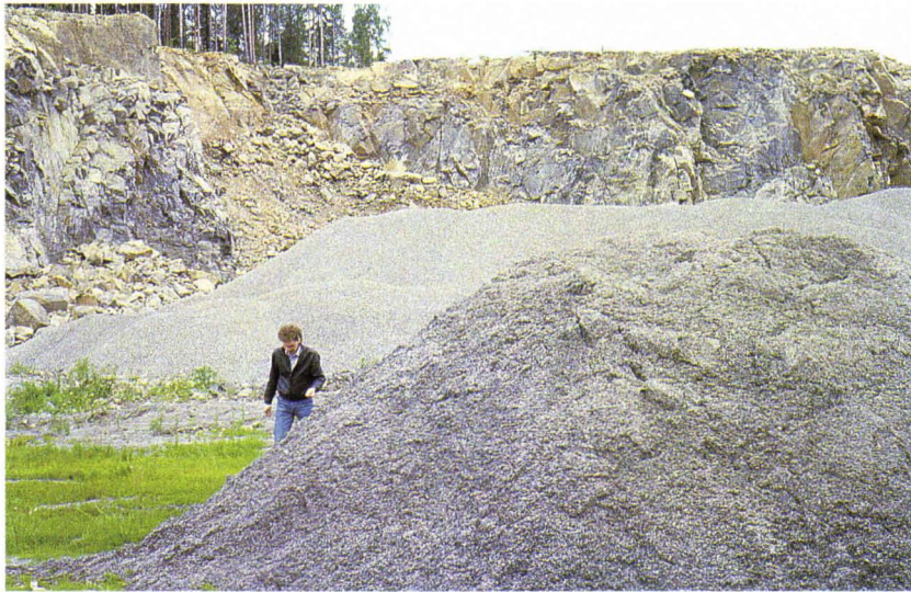
Kuva 9. Peltosalmen murskelouhos. Etualan kasoissa näkyy raekooltaan kahta erilaista murskaussepeä. Taustan kallioseinämässä vaalea kivi on migmatiittia ja tummat osuudet diabaasia. Valokuva Jukka Virtanen.
