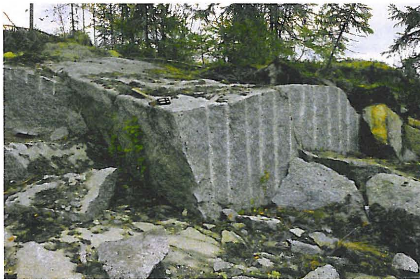
Fig. 18b. Juurusvesi tonalite (the commercial name Juankoski Grey) is used as dimensional stone. Ylä-Pieksä, Juankoski. Photo, O. Äikäs.
