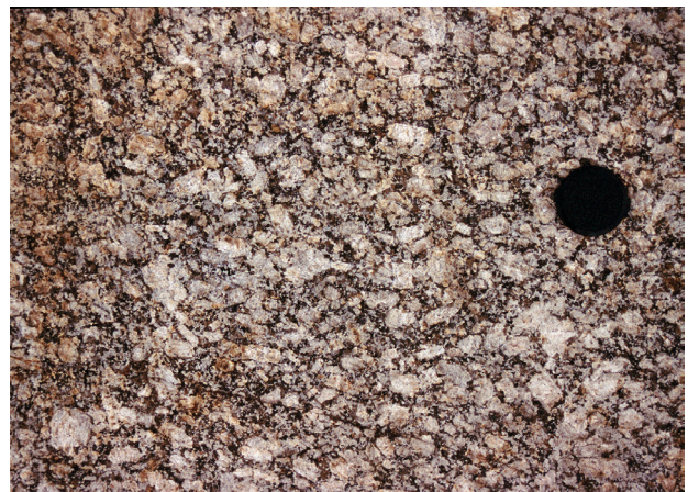
Kuva 6. Postkinemaattinen, porfyryinen kvartsimontsoniitti. Linsinsuojuksen läpimitta 5 cm. Luopa (x = 6946.40, y = 2429.20).
