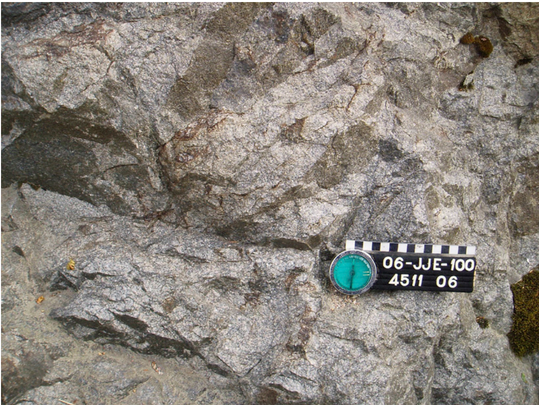
Kuva 46. Ruhjeinen tonaliitti havaintokohteella JJES-2006-100 (R5242H, E=571 726, N=7237 347). Kyseinen havaintokohde osuu Auhon siirroksen itä-läntiselle jatkeelle Näljängän itäpuolella. Mittakaavassa 1 cm jaotus. Kuva: Jukka Eskelinen. Figure 46. Fractured tonalite at location JJES-2006-100 laying on the east-west continuation of the Auhon fault east of Näljängä. Scale bar with 1 cm intervals. Photo by Jukka Eskelinen.
