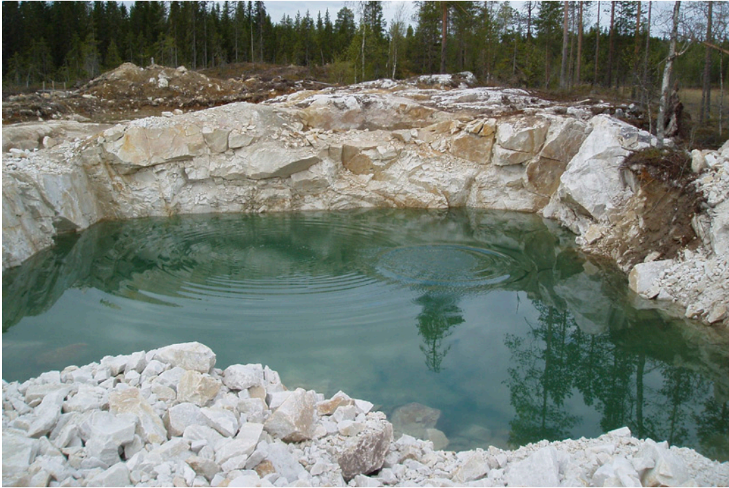
Kuva 35. Morenia Oy:n louhos Leppilammen kvartsijuonessa Pirttijärven länsipuolella (R5234E, E=584 222, N=7210 770). Kvartsia louhitaan värinsä vuoksi käytettäväksi koristemurskeena. Kuva: Esa Pohjolainen. Figure 35. Leppilampi quarry operated by Morenia Oy on the west side of Pirttijärvi. Vein-quartz is used as decorative aggregate. Photo by Esa Pohjolainen.
