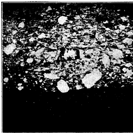
Fig. 7. Mikroskopiskt preparat af hvarvig fyllit från trakten af Ajonokka i Messuby. Snittet afskär gränsen mellan tvänne hvarf. Förstor. 18 ggr.
