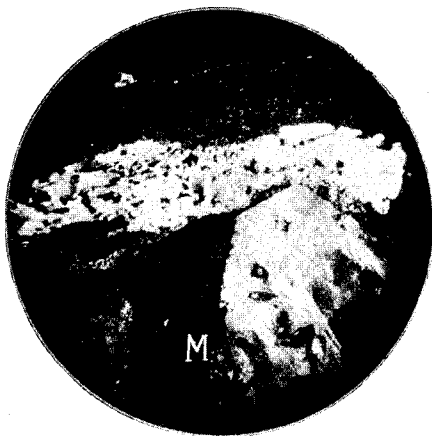
Fig. 48. Kvartskristall i kvartsporfyren från Sarakallio i Karvia, som sönderpressats och böjts kring kanten af en mikroklinkristall. Pol. ljus. Förstor. 10 ggr.
