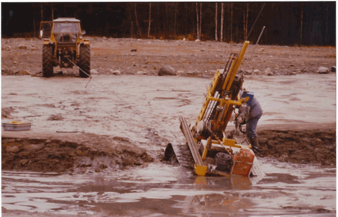
Kuva 4 A-sondin nostoyrityksiä traktorilla käyttäen apuna vanhoja kaivoksen hissivaijereita. Taustalla on sora-kerroksella peitettyä jätealuetta.
