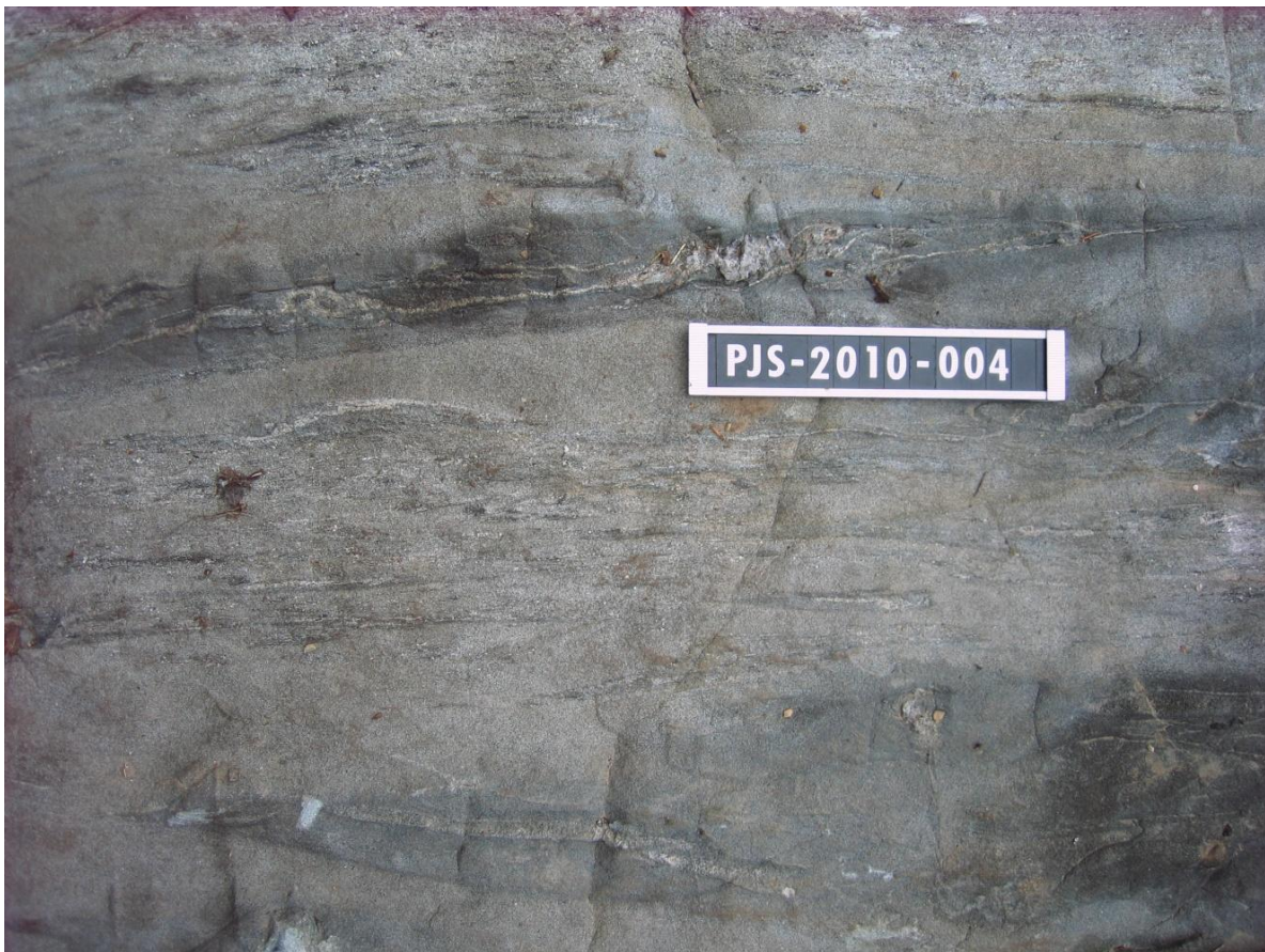
Kuva 3. Kerroksellinen intermediäärinen, ilmeisesti uudelleenkerrostunut tuhkasedimentti. Laatan pituus 16 cm. y=6729739;x=312061.
