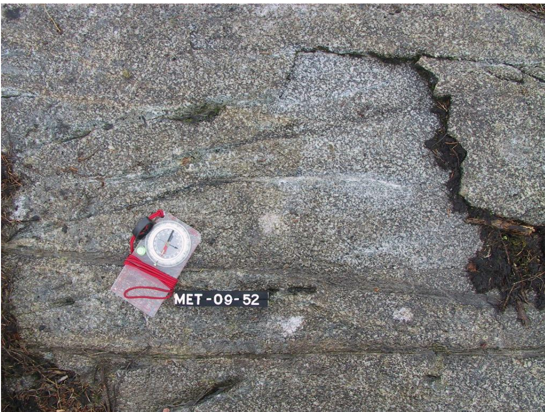
Kuva 6. Intermediäärinen plagioklaasiporfyriitti. Laatan pituus 10 cm. y=6756914;x=308248.
