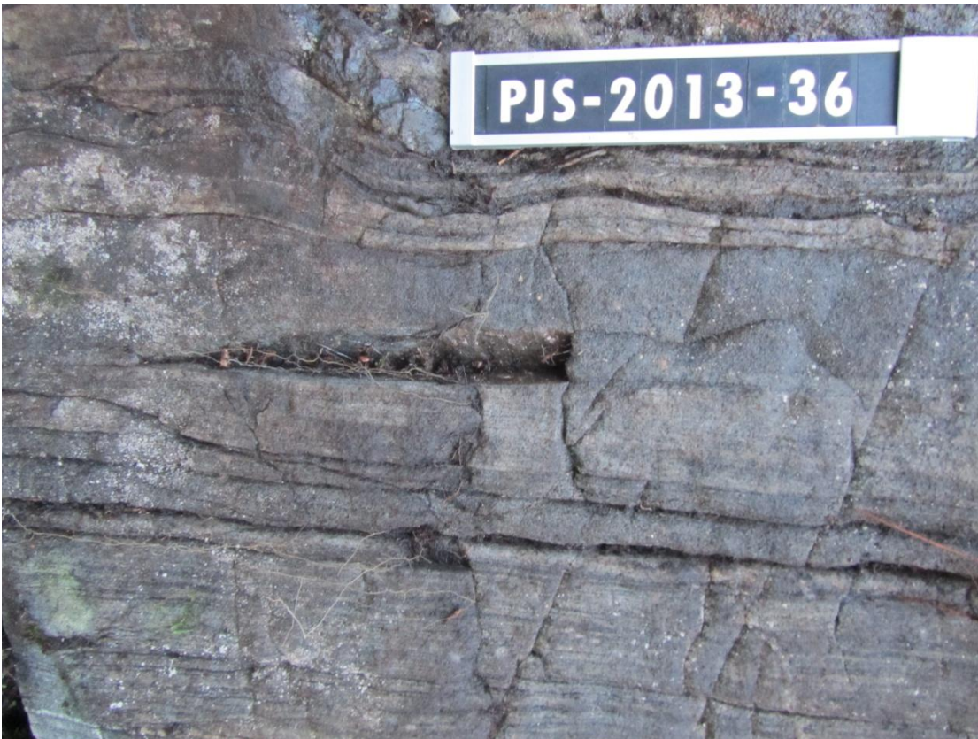
Kuva 7. Raitainen amfiboliitti, mafinen. Laatan pituus 16 cm. y= 6770744;x= 301841.
