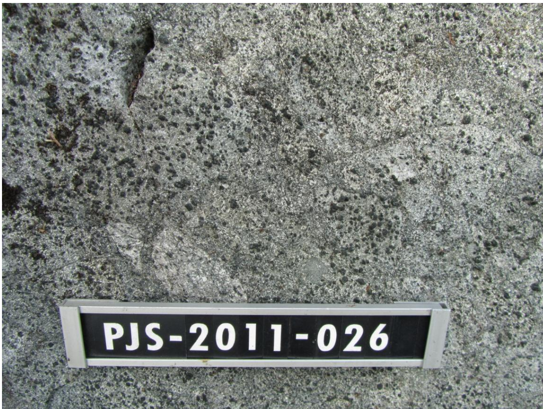
Kuva 5. Breksiarakenteinen uraliitti-plagioklaasiporfyyriitti. Tammela, Pikonkorpi. Numerolevyn pituus on 16 cm. y=6759635; x=330422.
