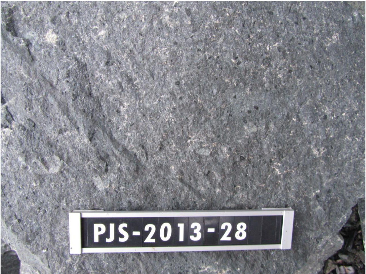
Kuva 5. Mafinen massiivinen uraliitti-plagioklaasiporfyriitti, jossa on felsisempiä fragmenttejaLaatan pituus 16 cm. y=6767959;x=352261. Sepelilouhos.
