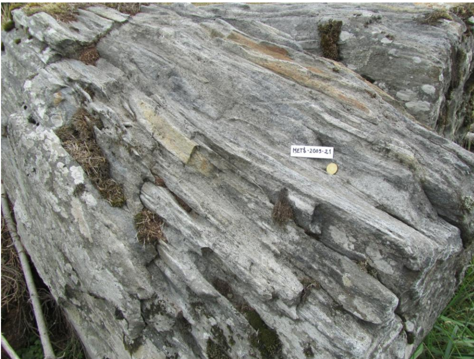
Kuva 8. Punkalaidun, Huhtamo. Voimakas venymä vulkaanisessa konglomeraatissa. Klastit ovat pääosin intermediääristä vulkaniittia, jonkin verran on myös felsisiä ja mafisia. Kuva paikallisesta lohkarresta 2-tien kalliioleikkauksen itäpuolelta. Merkkilapun pituus 11 cm. y= 6778681; x= 279101.
