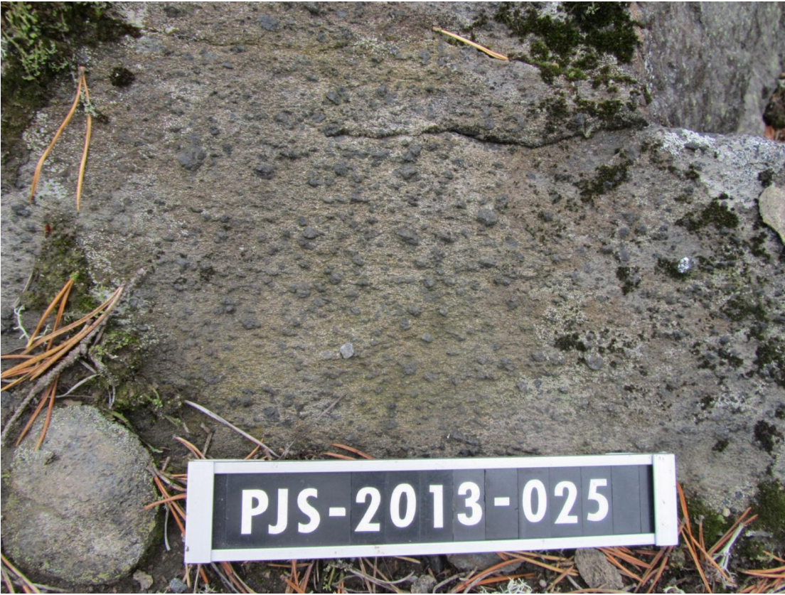
Kuva 7. Massamainen mafinen uraliittiporfyyriitti. Laatan pituus 16 cm. y= 6757275;x=300123.
