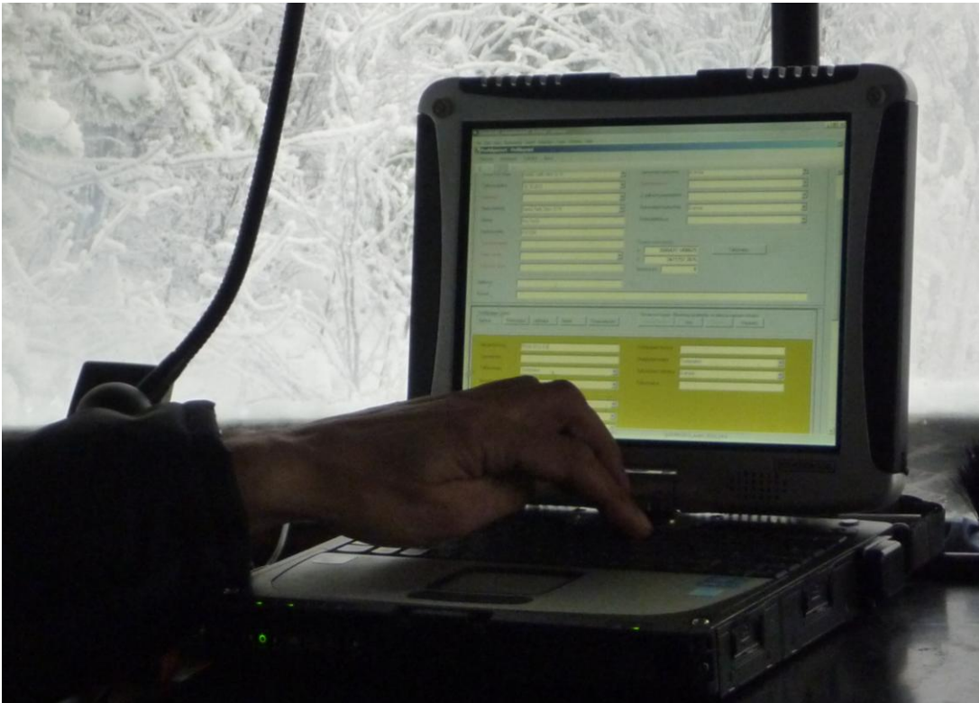
Kuva 2. Näytetietojen tallentaminen Maapeli-sovelluksen havaintolomakkeelle näytteen ottamisen jälkeen. Lomake aukeaa ja paikkatiedot tallentuvat lomakkeelle automaattisesti, kun työkalulla klikataan kartalla näytteenotto- teen kohdalla.
