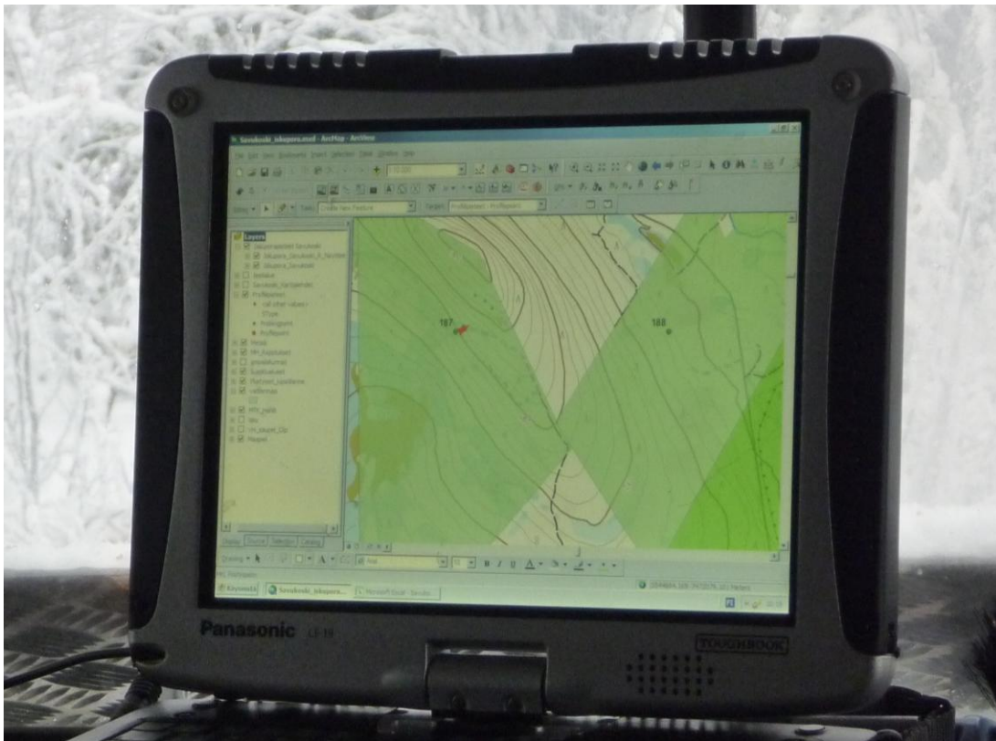
Kuva 1. Maastotallentimessa näkyvät ArcMap -projektiin tuodut aineistot eli pohjakartta-aineisto, jossa näkyy mm. tiestö, suunnitellut näytteenottopisteet sekä kiinteistörajat lupatietoineen. Punainen nuoli osoittaa koneen sijaintipaikan. Kartalla on vihreällä esitetty ne alueet, joille on saatu lupa maastossa liikkumiseen sekä näytteenottoon.
