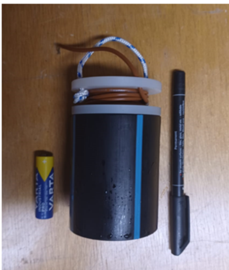
Kuva 62. Polarisoitumaton lyijykloridielektrodi ( PbCl_2 ).
