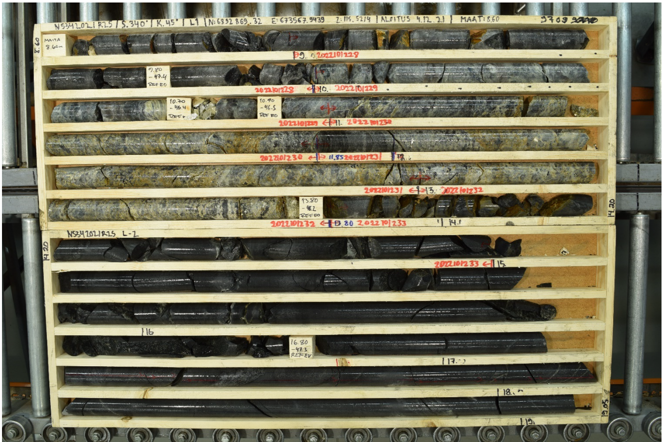
Kuva 55. R25 lävistää Li-pegmatiitin pohjan vain muutaman metrin matkalta. Pegmatiitti on pääasiassa cleavelandiittipegmatiittia.
