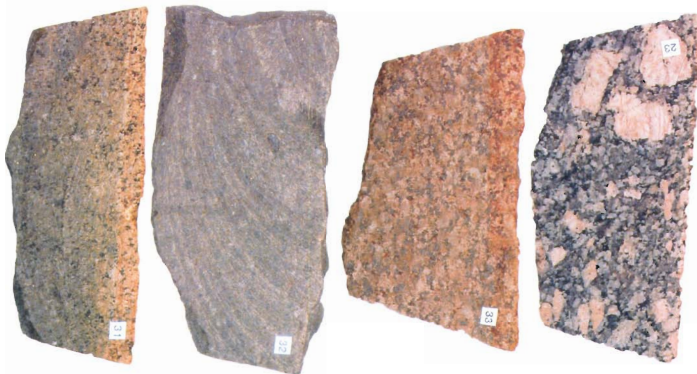
Kuva 8. Tasarakeisia rapakivigraniitteja eri kunnista, näyte 31 = Lappeenranta (65PAH98), näyte 32 = Ylämaa (222MJT99) ja näyte 33 = Ylämaa (7MTP00). Näyte 23 = Porfyyrinen granodioriitti, Lappeenranta (90RR98). Kuva: Jari Väätäinen.
