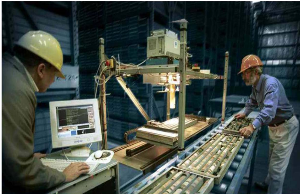
Kuva 7 HyLogger ja sen kehittäjä Jon Huntington oikealla. (Ks linkki kirjallisuusviitteissä: HyLogger esittely).
