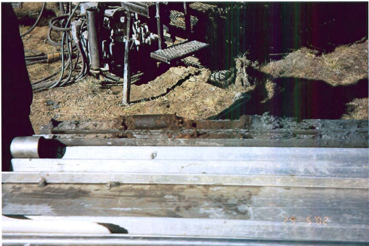
Kuva 7. Kairausprofiili rikastushiekan ja pohjamaan kontaktista, kerrokset oikealta vasemmalle: veden kyllästämä rikastushiekka, tiivistynyt kuiva turve ja kuiva hieno hietä, Hammaslahden vanhan kuparikaivosalue.
