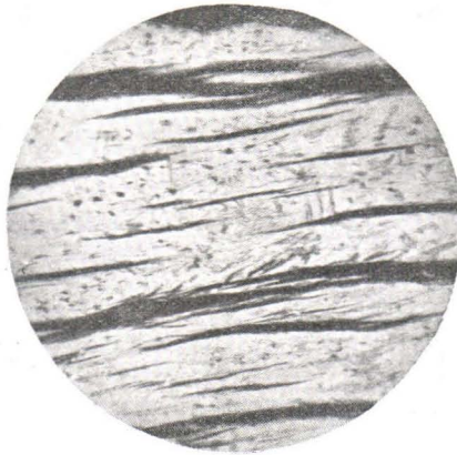
Fig. 17. Einfacher Mikroklin mit Perthitschnüren. Härkäsaari. Schnitt nach (001). Nicols +. Vergr. 9.
