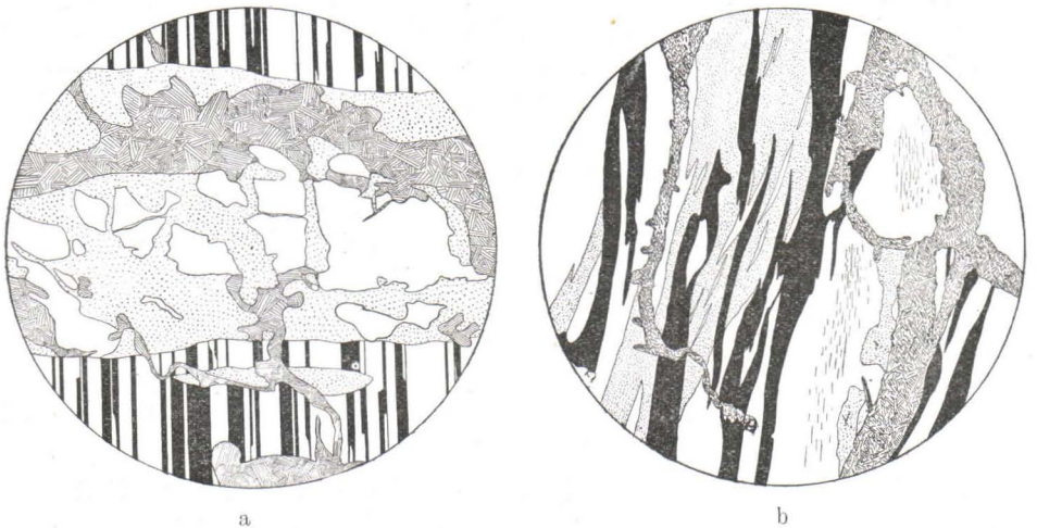
Fig. 21. Umwandlung von Mikroklinperthit in Muscovit. Weiss=Mikroclin. Weiss mit schwarzen Lamellen und schwarz=Albit. Gestrichelt=Muscovit. Punktirt=Anorthoklas. Nicols +. Vergr. bei a 60 \times , bei b 54 \times .
