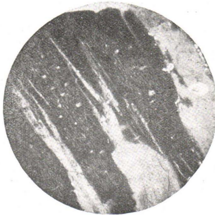
Fig. 20. Mikroklinperthit, Härkäsaari. Schnitt nach (010). Nicols +, Vergr. 25.
