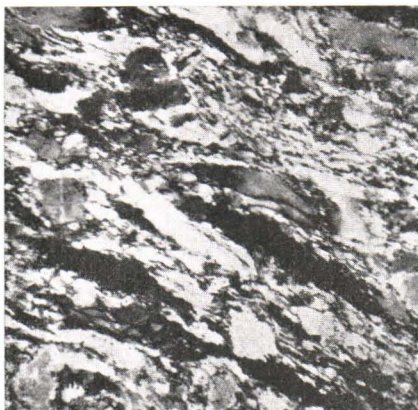
Fig. 5. Tektonoblastische Struktur in feldspathaltigem Quarzit beim Gehöft Koivula, Puolanka. Vergr.
