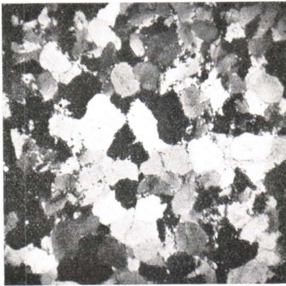
Fig. 21. Granoblastischer Quarzit als Zwischenlager im Jokijyrkkä-Konglomerat. Vergr. 12 \times , Nik. +.
