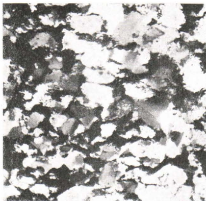
Fig. 37. Dynamische Einflüsse im klastischen Quarzit mit Zement von Hämatit (vgl. Fig. 23). Aylö, Puolanka, Vergr. 25 \times , Nik. +.
