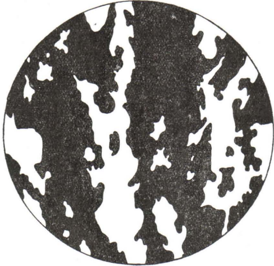
Abb. 10. L h . Nuolait. Nuolainniemi. Schwarz = opaker Teil. Weiss = durchscheinend, beinahe farblos, isotrop. Vergr. 100.
