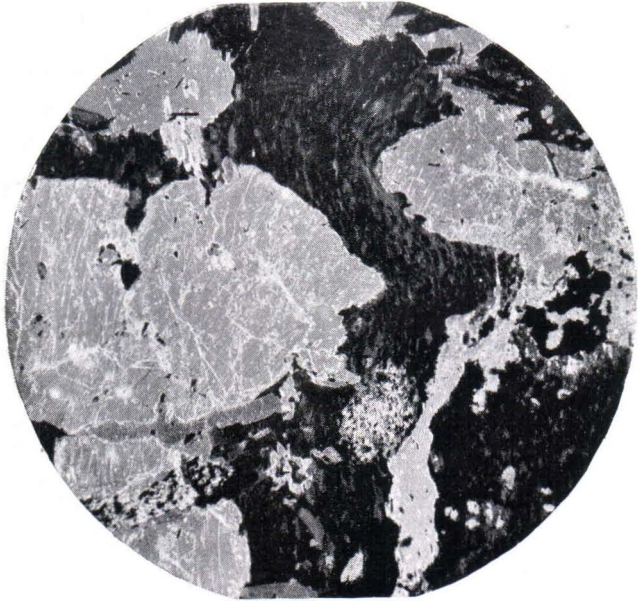
Abb. 5. Skapolithamphibolit, Ylläsjärvi, Kolari. Gew. Licht. Vergr. 4. Hell grau = Skapolith, dunkel = Biotit + Hornblende.
