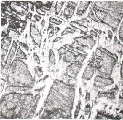
Fig. 1. Anschliff. Ungeätzt. Vergr. etwa 75. Ohne Nicol. Schwefelkies (grau) wird von Kupferkies (weiss) längs Spalten verdrängt. Grube Edward Meyer. Pitkäranta.
