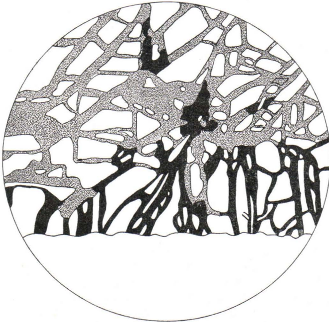
Fig. 6. Anschliff. Vergr. 100. Schwefelkieskristall (weiss) wird von Magnetkies (grau) und Kupferkies (schwarz) verdrängt. Die Kante des Schwefelkieskristalls ungefähr parallel mit der unteren Bildkante. Outokumpu.
