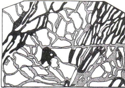
Fig. 5. Anschliff. Vergr. 60. Schwefelkieskristall (weiss) wird von Magnetkies (grau) und Kupferkies (schwarz) verdrängt. Nach einer Photographie gezeichnet. Outokumpu.
