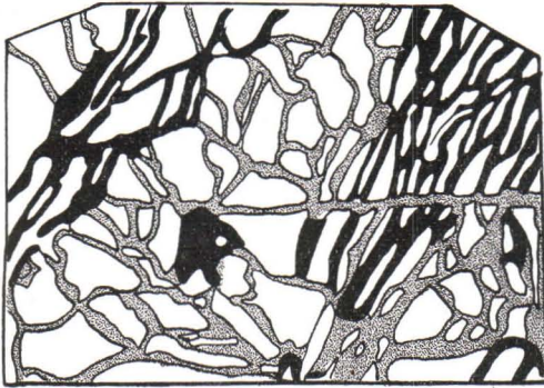
Fig. 4. Verdrängung von Pyrit (weiss) durch Magnetkies (grau) und Kupferkies (schwarz) im Erze von Outokumpu nach Laitakari.
