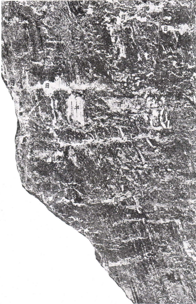
Fig. 2. Kieserz von Outokumpu, entstanden durch Imprägnation von Quarz.
