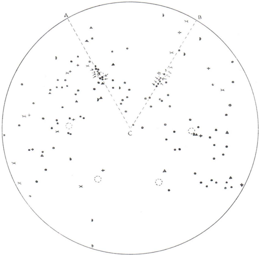
Abb. 6. In der Zusammenstellung zeigen vier auf verschiedene Weise bezeichnete Projektionsbilder die Flächenlage in den einzelnen Fällen. Wagerechte und stark geneigte Flächen kann man nicht messen. Deshalb muss der untere Teil der Figur flächenarm bleiben, nachdem die C-Achse senkrecht gestellt worden ist.
