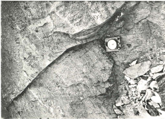
Abb. 2. Mylonitisierter silikatreicher Kalkstein, Grenzlager zwischen Kalzitmarmor und Dolomitmarmor, SW-Wand des Steinbruches. Original.
