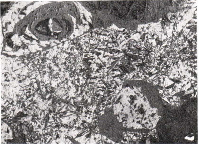
Fig. 60. Imprägnationserz im Vorkommen vom Kammikivintunturi. Die Sulfidminerale sind auch in die Pseudomorphose eingedrungen. Die sekundären Minerale sind in das Erz eingeschlossen worden. Anschliff, Vergröss. 130  $\times$ .
