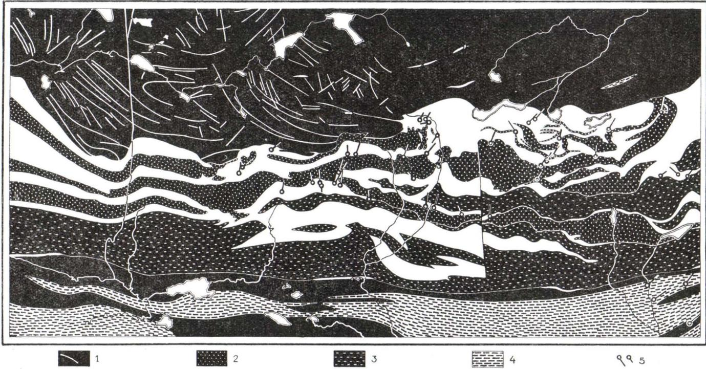
Fig. 8. Die Tektonik des Gebietes Kaulatunturi—Kammikivinturi. 1. Diabase mit Bruchspalten, 2. Intrusive, 3. Dolerite, 4. Tuffschiefer, weiss Phyllit, 5. Faltenachsen. Massstab 1:50,000. Die Nordrichtung ist nach unten.
