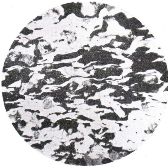
Abb. 4. Aus dem westlichen Erz von Hästö Utterharu. Magnetit (schwarz), Quarz (weiss) und trüber Amphibol (grau). Vergr. 32 \times . Nic. //.
