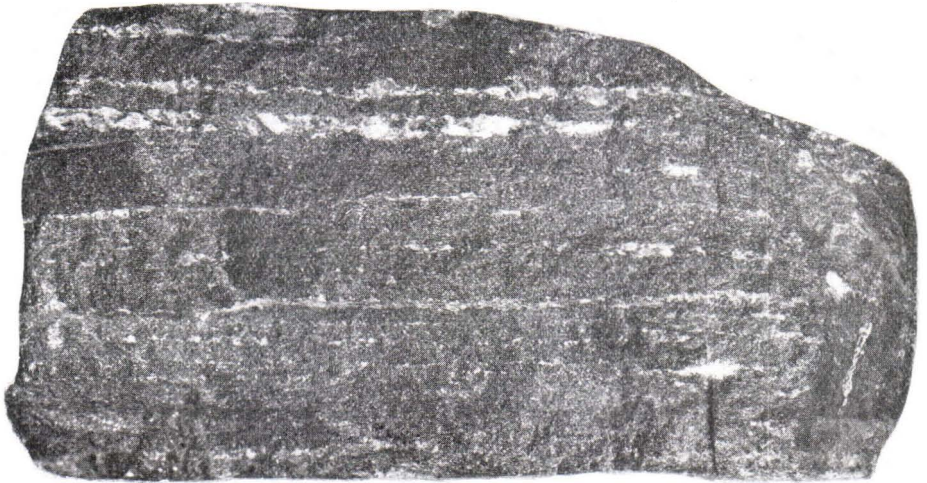
Abb. 3. Gebändertes Erz. Die hellen Bänder bestehen aus Quarz und rotem Mikroklin. Hästö Utterharu. Nat. Grösse.
