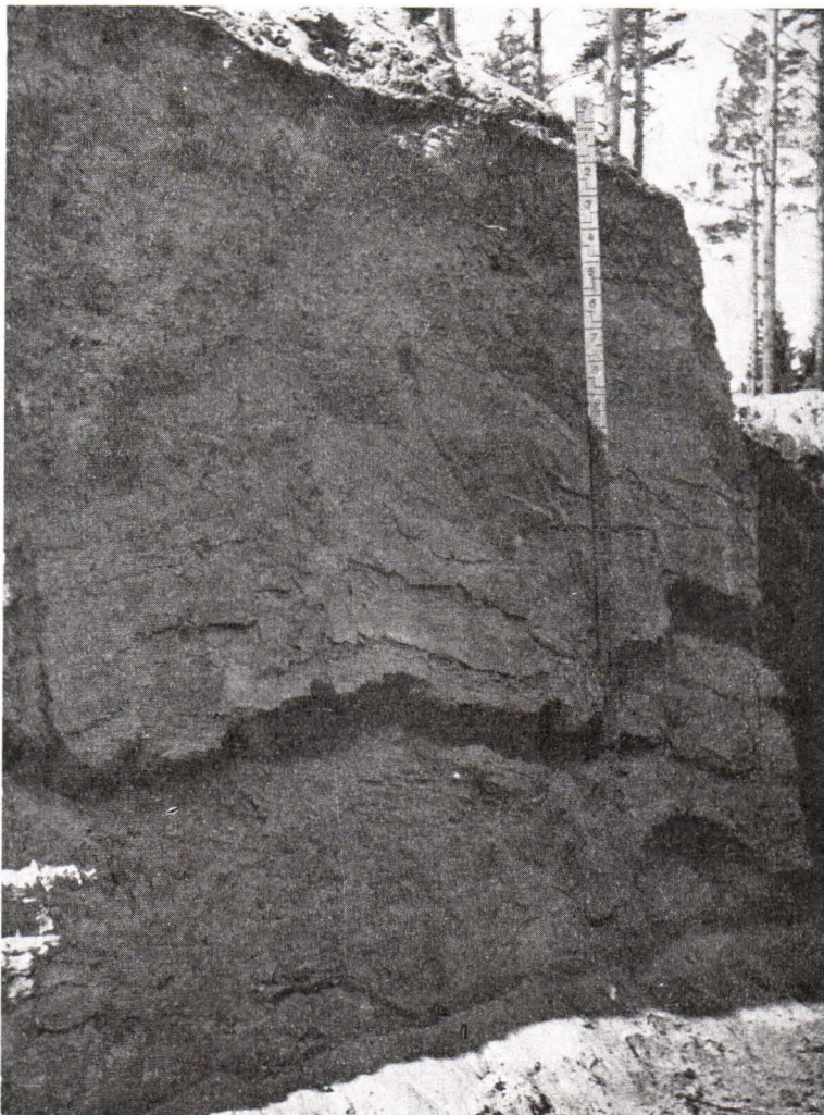
Abb. 3. Feinverteilte Bodenarten, Schluff- und Sandablagerungen unter Moräne. Die untere Grenze der Moräne geschlängelt. Karelische Landenge, Valkeasaari, Gelände von Suur-Kivi.
