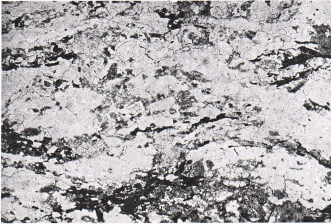
Fig. 41. «Microcline gneiss». S. shore of Lake Pukalanselkä, Orivesi. The discontinuous white stripes are microcline. Nic. ||, magn. 20 ×.
