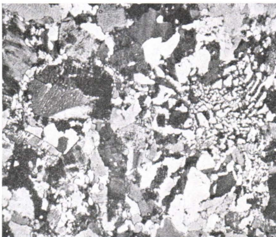
Fig. 19. Aplitic granite in a pebble of conglomerate. N. E. of Lake Sisällyspohja, Teisko. Nic. +, magn. 32 \times .
