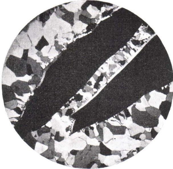
Fig. 19. Bruchstücke von brauner Zinkblende (schwarz), deren Zwischenräume von Quarz ausgefüllt sind. Schurfschicht Beck, Hopunvaara, Pitkäranta. + Nicols. Vergr. 22 \times .
