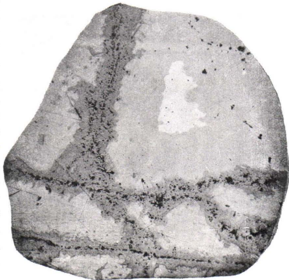
Fig. 7. Zinkblende (grau) verdrängt Bornit (grauweiss). Weiss ist Kupferkies. Grube Toivo, Pitkäranta. Vergr.
