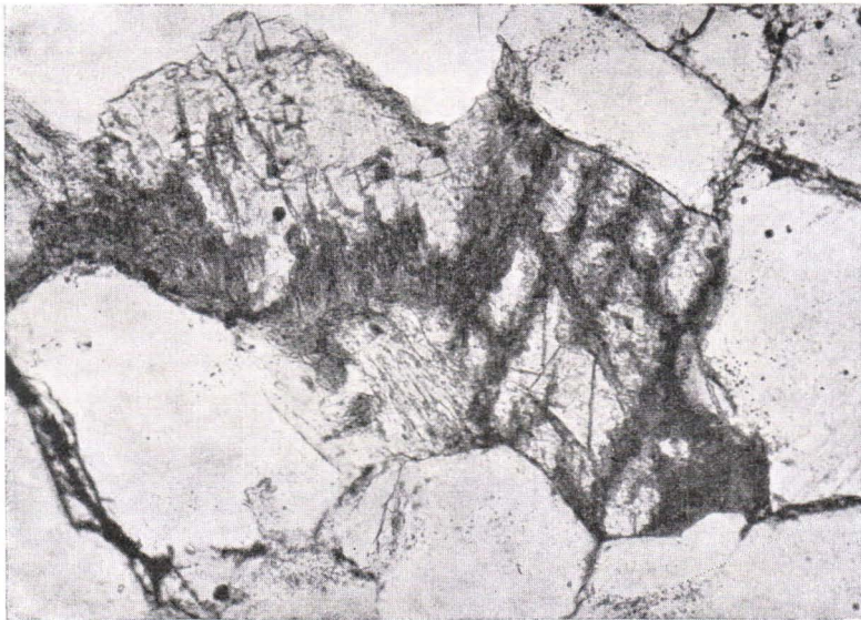
Fig. 4. Ein teilweise serpentinisiertes Dolomitmorn in Quarzit. Gebändertes Erz im Erzgeschiebe von Kivisalmi. Vergr. 135 \times .
