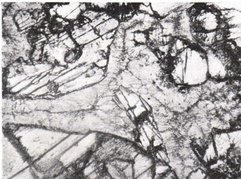
Fig. 15. Hohlräume in Diopsidskarn, die mit äusserst feinfibrigem Serpentin ausgefüllt sind. Schwarz ist hauptsächlich Kupfer, das teilweise in Cuprit umgewandelt ist. Grube 1. Schwartz, Pitkäranta. Durchlicht. Vergr. 104 \times .
