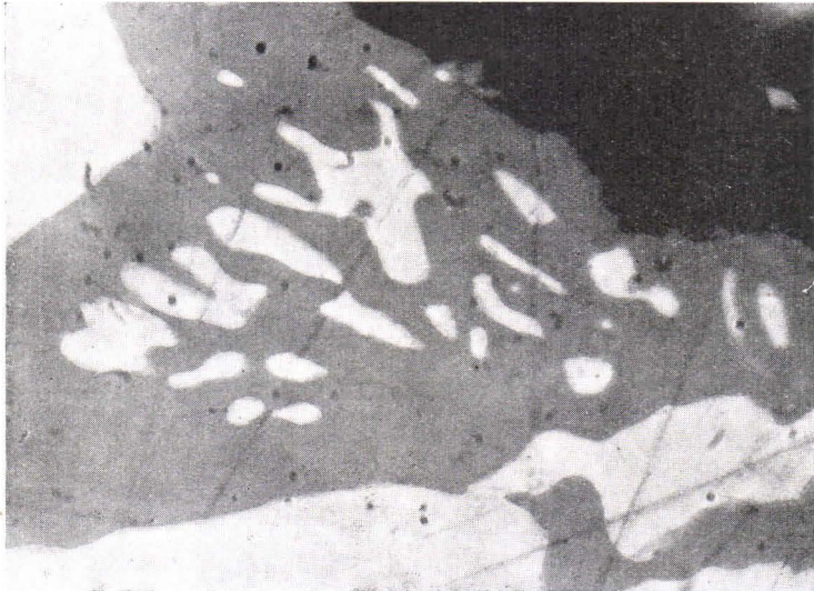
Fig. 8. Kupferglanz (hellgrau) und Bornit (dunkelgrau). Grube Schwartz, Pitkäraanta. Vergr. 1115 \times . Ölimmersion.
