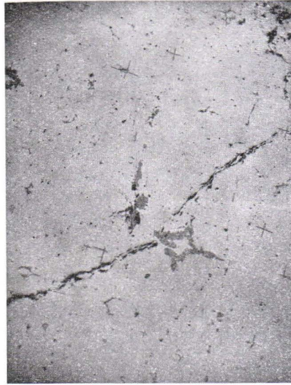
Fig. 15. Zinkblendesternchen in Kupferkies. Die Strahlen der Sternchen sind alle gleich orientiert. Anschliff, Vergrößerung 12fach.
