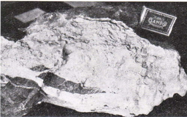
Fig. 36. Karbonatgang in Serpentin. Randlich abgebrochene Serpentinbrocken schwimmen in der Füllung.
