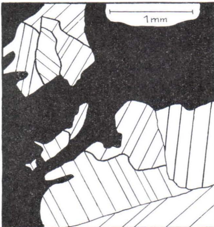
Fig. 9. Dolomiteinschlüsse (weiss) in Serpentin (schwarz). Die Schraffur entspricht der Parallelstreifung des Dolomites.
