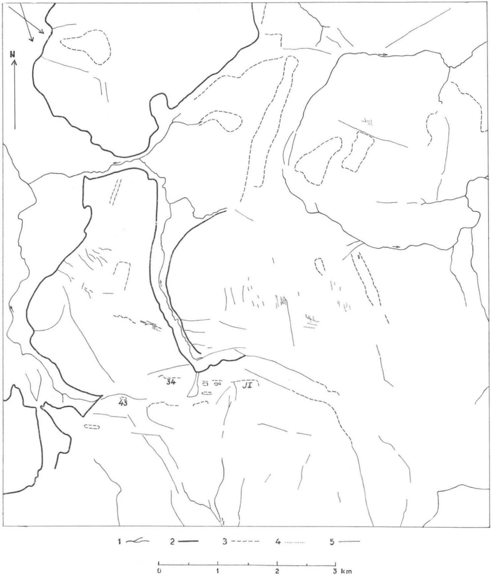
ABB. 13. Photogeologische Karte des grösseren Gebiets um Jauratsi. 1, Wasserläufe, 2, grössere geschlossene Komplexe, 3, markante Geländekanten, 4, Klüftung, 5, Photolineation.
