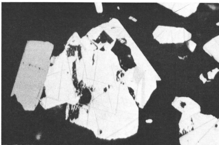
Abb. 38. Erzführende Schmitze aus Metagrauwacke. Körniger und leistenförmiger Hämatit (weiss oder hellgrau) mit Ilmenitlamellen. Die Lamellen haben verschiedene Dicke und Richtung. Sie durchsetzen das ganze Korn oder laufen spitz aus. Anschliff Nr. 63, (Nr. 27/64), Vergr. 930-fach, Ölimmersion, 1 Nicol.
