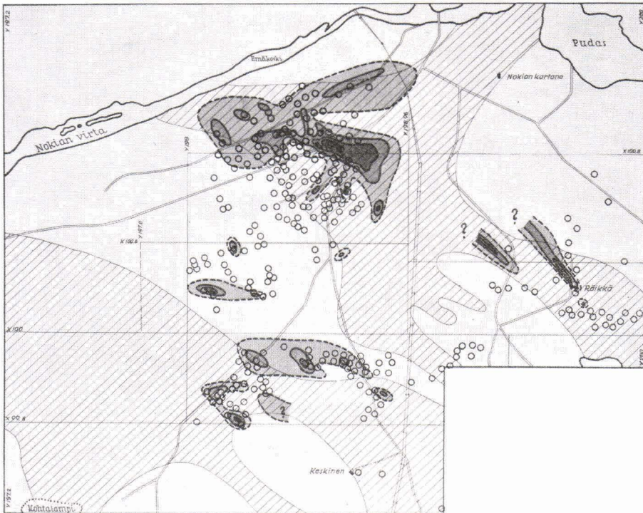
Kuva 4. Sinkin konsentrationikäyrät (pohjavesissä) ja magneettiset häiriöalueet (vinoviivoitettu alue) Nokian Koskenmäellä. Sinkin konsentrationikäyrät vastaavat, ulkoa sisänpäin, seuraavia Zn-pitoisuuksia.
