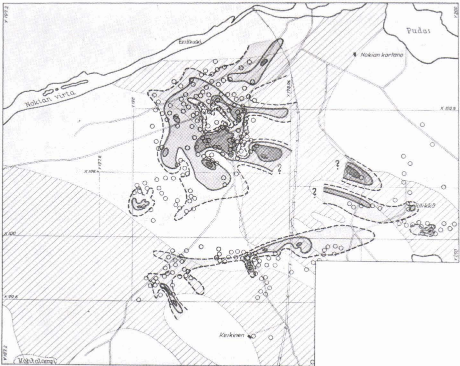
Kuva 3. Kuparin konsentrationikäyrät (pohjavesille) Nokian Koskenmäellä, sekä magneettiset häiriöalueet (vinoviivoitettu alue). Kuparin konsentrationikäyrät vastaavat, ulkoa sisänpäin, seuraavia Cu-pitoisuuksia: 10, 20, 40, 80 ppm. Ympyrät merkitsevät näytteiden ottopaikkoja.
