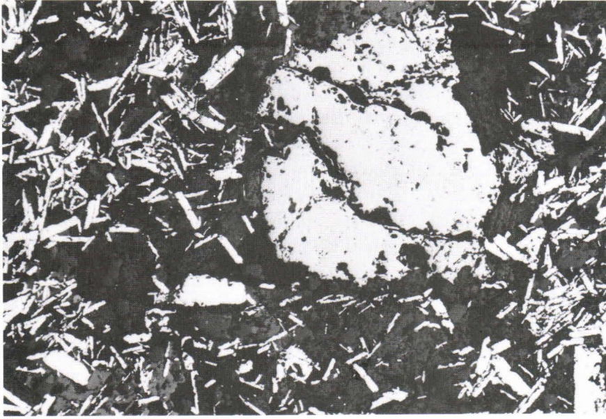
Kuva 20. Hematiitti- ja magneettipitoista serisiittiliusketta, Suonna, Posio. Vaaleat liistakkeet ovat hematiittia, tummempi porfyroblasti on magnetiittia. Pintahie, n. 50 x.
