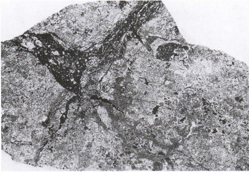
Kuva 14. Rautamuodostuman hematiittifasies, Vuossavaara, Kittilä. Musta on hematiittia ja vaalea kvartsia. Huomaa munuaismaiset geelirakenteet (esim. kuvan vasemmassa reunassa). Ohuthie, 4 x suurennos.
