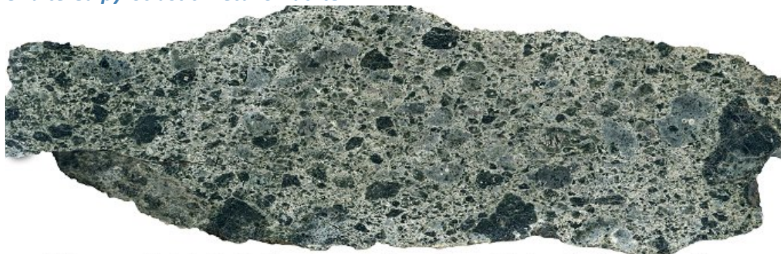
Pahtavaara, Sodankylä. Unaltered, pyroclastic metakomatiite from the Sattasvaara Group, Pahtavaara. Mineral assemblage: tremolite - talc - dolomite(?) - chlorite. Primary volcanoclastic textures are well preserved. Field of view 17 cm. Photo Jari Väättäinen.
