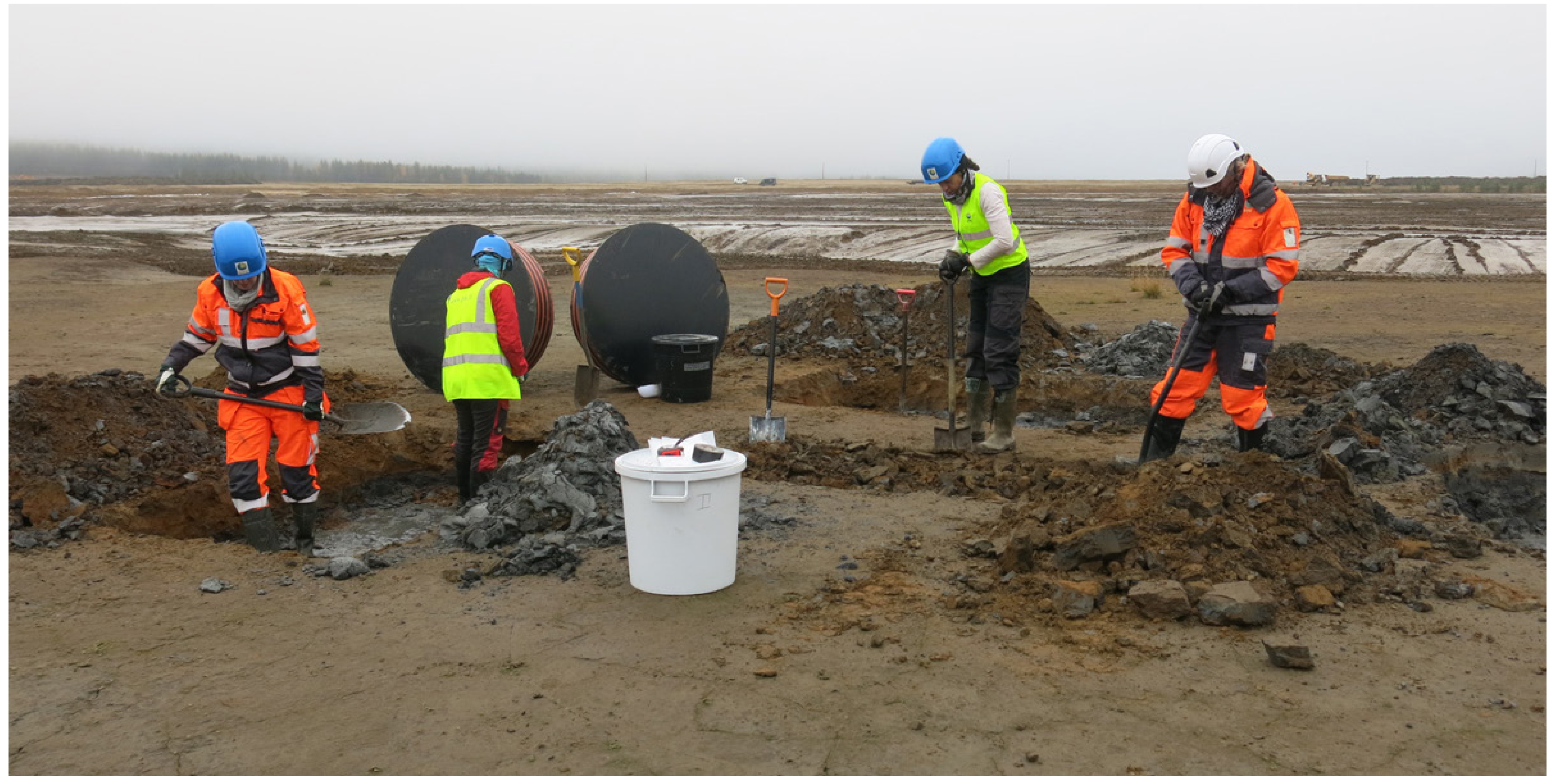
Lysimetrien asennusta Rautuvaaran rikastushiekka-altaalla peittorakenteen in-situ-testausta varten.
