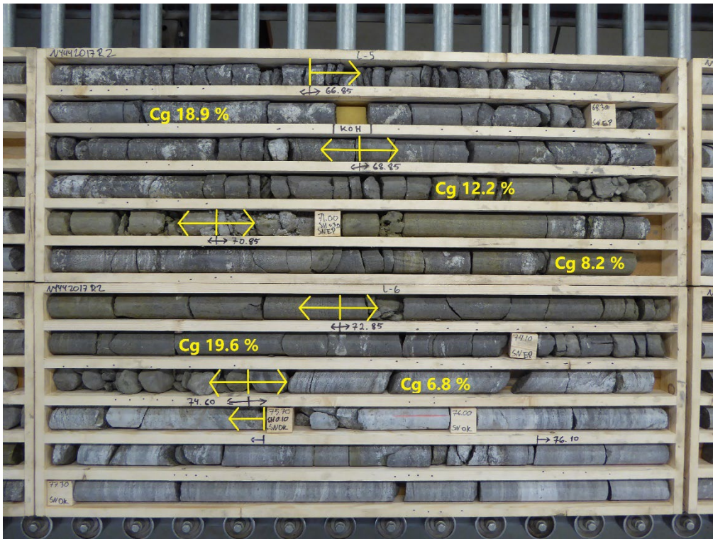
Kuva 7. Kairasydänvalokuva reiän N4442017R2 grafiittilävistyksestä syvyydeltä 66,85–75,70 m. Koko yhtenäisen grafiittilävistyksen näytepituudella painotettu Cg keskiarvo alkaen syvyydeltä 62,85 m on 12,5 %.
