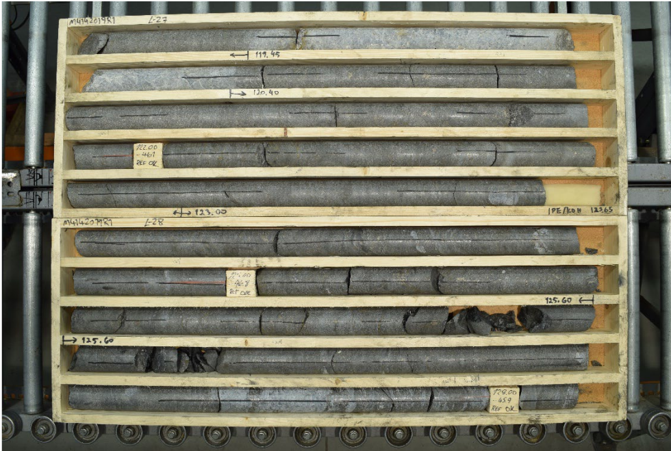
Kuva 5. Reiän M4142019R1 grafiittikiveä. Näytevälin 120.4 – 123 m Cg pitoisuus on 11,7 % ja välin 123 – 125,6 m 12,1 %.
