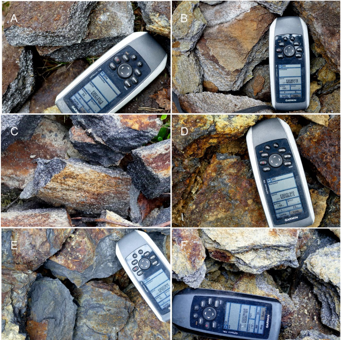
Kuva 1. Grafiitti lohkarenäytteissä. A) Karkeasuomuinen ( \phi > 1 mm) grafiittigneissi (STL2-2022-94.1.1), 3.73 p-% C_g , 3.16 p-% S_{tot} (Hedet, Närpiö, Pohjanmaa). B) Karkeahkosuomuinen ( \phi \approx 1 mm) grafiittiliuske (STL2-2022-8.1.2), 10.40 p-% C_g , 0.26 p-% S_{tot} (Linjasuo, Luopioinen, Pälkäne). C) Suomuinen ( \phi < 1 mm) grafiittiliuske (STL2-2022-389.1), 4.02 p-% C_g , 3.25 p-% S_{tot} (Saarijärvi, Ulvila, Satakunta). D) Suomukasvua ( \phi \ll 1 mm) mustaliuskeessa (STL2-2022-249.1.2), 10.65 p-% C_g , 6.18 p-% S_{tot} (Hakopatteus, Kaavi, Pohjois-Savo). E) Mustaliuske, hienorakeinen grafiitti (STL2-2022-370.1.1), 7.60 p-% C_g , 5.80 p-% S_{tot} (Haarakangas, Kaustinen, Keski-Pohjanmaa). F) Keltaokraa grafiittiliuskeessa (helposti lohkeava), karkeahkosuomuinen ( \phi \approx 1 mm) raekoko (STL2-2022-429.1), 8.38 p-% C_g , 2.38 p-% S_{tot} (Kiikkukangas, Juva, Etelä-Savo). GPS-laitteen leveys 7 cm.
