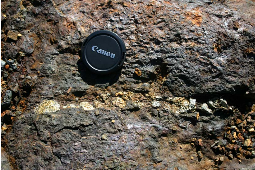
Kuva 1. Mustaliusketta Talvivaaran esiintymässä Sotkamossa. Rikkikiisu kiiltelee kellertävänä juuri paljastetun kallion pinnassa. Kuva: Kirsti Loukola-Ruskeeniemi, GTK.
