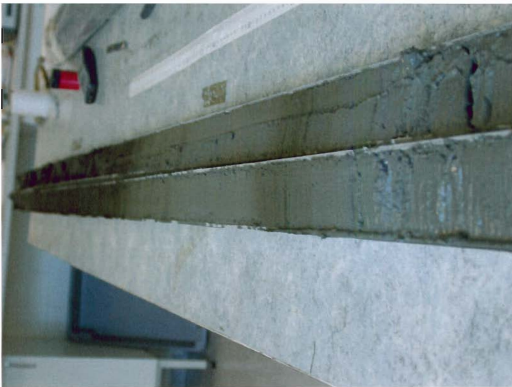
Kuva 11. Järvisedimenttinäyte avataan tutkimuslaboratorion pöydällä sedimenttirakenteiden kuvaamista ja näytteenottoa (mm. siitepölyt) varten.
