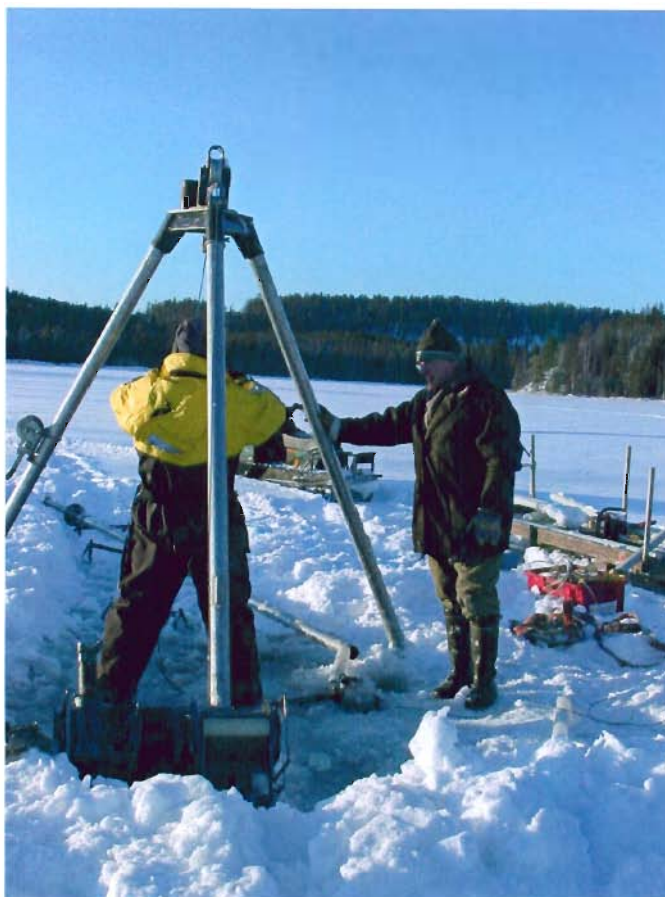
Kuva 8. Järven pohjasedimentinäytteenottoa Repoveden kansallispuistossa keväällä 2004 S.Putkisen (GTK) kehittämällä raskaalla mäntäkairalla.
