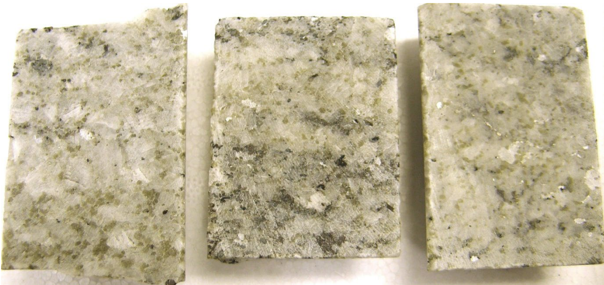
Kuva 15. Apatiittirikkaita dolomiittikarbonaattiteja. Vasemmalta oikealle R17 145.60, R15 172.10 ja R17 71.35. Sahaamalla halkaistujen kairasydänten leveys on 40 mm.
